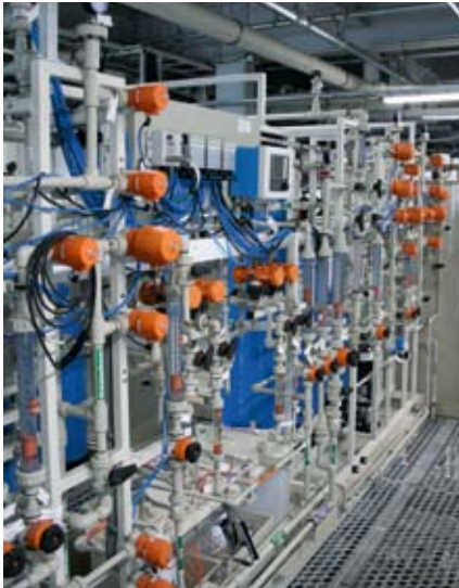
lonexová cirkulační kolona řízená terminálem MPA-S s odpojovacími deskami.
