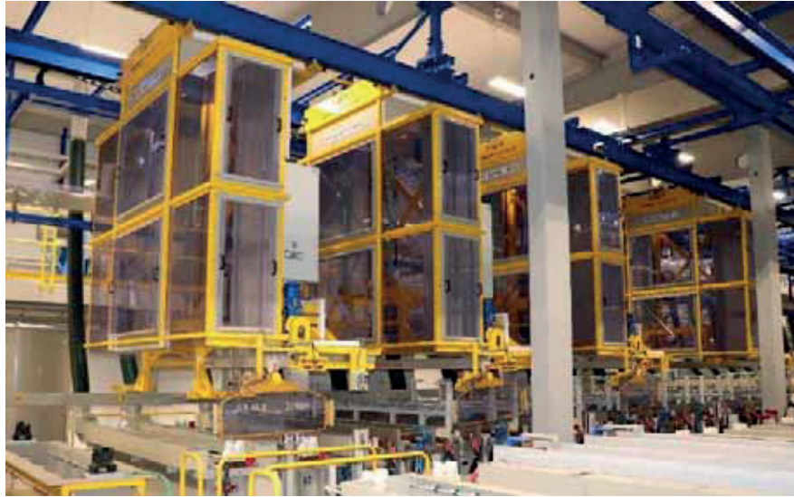
Obr. 3: Dopravní manipulátory s odkapovou vaničkou a odsávanou kabinou
